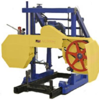
**Ленточная пилорама Астрон-9.01 mini** предназначена для изготовления пиломатериала-доски, бруса и др. из круглого леса.
