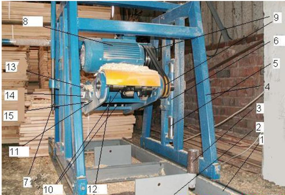
Состоит из основания(1) с закрепленными на нём горизонтальными направляющими, подставками под брус(2), упорами(3) и зажимами.
