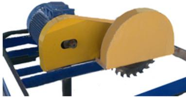
**Станок кромкообрезной РБК-100** предназначен для получения обрезной доски из необрезной.
